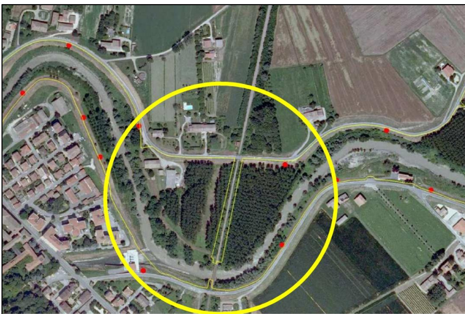
Figura 2-27: argine golenale in corrispondenza del ponte della ferrovia a Colorno. I punti rossi rappresentano la picchettatura della piena, le linee gialle sottili sono i confini del modello.
