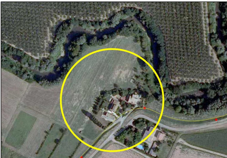
Figura 2-24: argine golenale presso via argine Baganzolino, a Nord del ponte dell'autostrada A1. In rosso sono rappresentati i punti della picchettatura della piena del Gennaio 2009.
