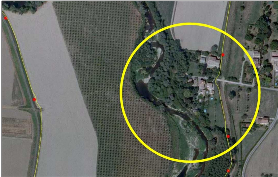
Figura 2-23: argine golenale presso Stradello Dazzi (laterale di via Moletolo), tra il ponte della tangenziale e il ponte dell'autostrada A1. In rosso sono rappresentati i punti della picchettatura della piena del Gennaio 2009.
