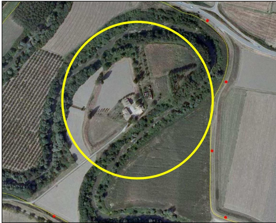
Figura 2-25: argine golenale in località San Siro, laterale della provinciale di Golese. In rosso sono rappresentati i punti della picchettatura della piena del Gennaio 2009, le linee gialle sottili identificano i confini della mesh.
